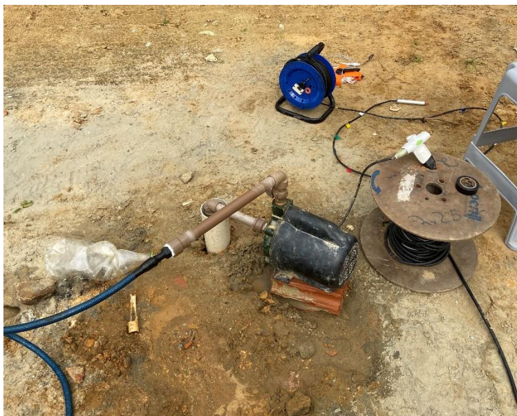
Figura 7: Teste de bombeamento executado com bomba aspirante e canalização para conduzir a água para a rede pluvial. Medição do rebaixamento de nível no poço de bombeamento com medidor de nível.
